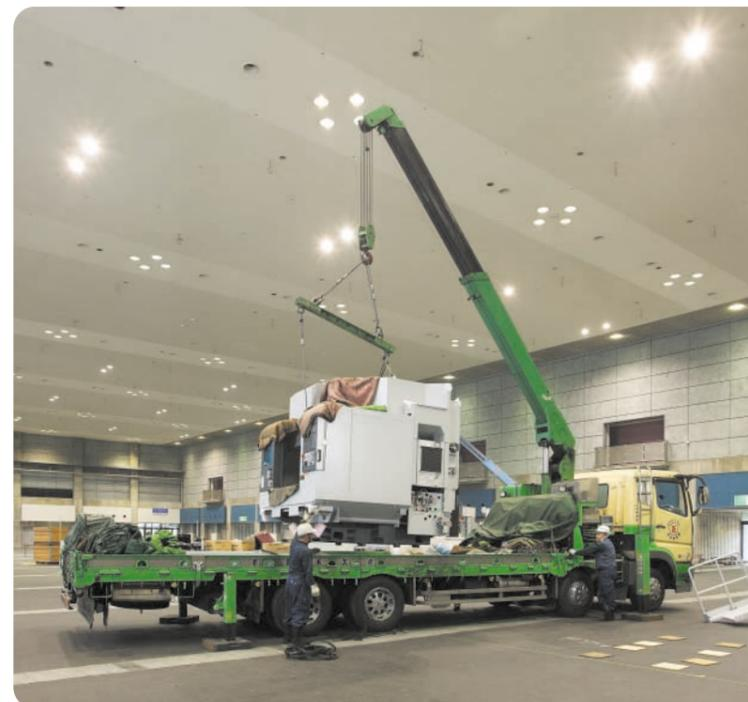
大展示場への搬入・搬出の際は、ワイドな搬出入口(3ヶ所)から会場内へクレーン車を直接乗り入れることができます。天井高は12mありますから、クレーンでの積み下ろし時も余裕を持って作業していただけます。アスファルト舗装を施した床は5t/m<sup>2</sup>の床荷重を誇り、大型機械などの重量物を展示する場合でも充分に対応。また、搬入道路も12mと広く、荷ぼき・組み立て作業もスムーズに行っていただけます。
